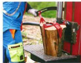
Linke Bedienungshebel mit integrierter Spaltgutfixierung und Spaltkreuz
